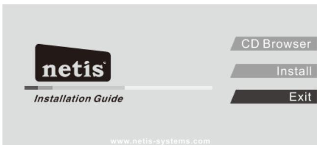
Clique em “**Install**”(Instalar). O assistente de driver inteligente da netis irá escolher o programa de driver correcto automaticamente baseado no seu sistema operativo Windows. A janela de **Assistente InstallShield** irá aparecer. Clique em “**Seguinte**” e siga os passos para concluir a instalação do driver.
