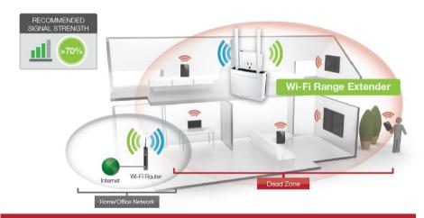
THE RANGE EXTENDER MUST RECEIVE A STRONG SIGNAL FROM YOUR WI-FI ROUTER.
