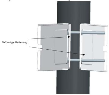
3. Stecken Sie die Ränder der V-förmigen Halterung in die Aussparungen in der rechteckigen Platte und ziehen Sie die Muttern fest an.
