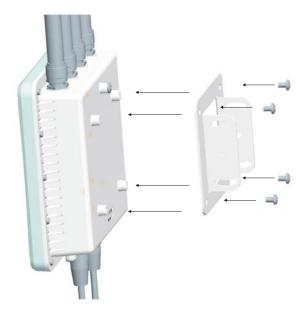
5. Befestigen Sie die Bridge mit Halter an der am Mast angebrachten Platte.
