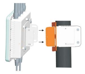
Befestigen Sie die drahtlose Bridge mit den beigefügten Muttern an der Halterung. Berücksichtigen Sie dabei die Ausrichtung der Antennenpolarisierung; alle Antennen in einem Link müssen mit derselben Polarisierung montiert werden.
