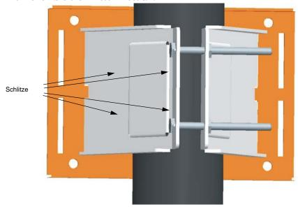
$4.\;\;$  Befestigen Sie die verstellbare, rechteckige Platte mit den beigefügten Schrauben an der Bridge.
