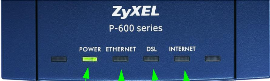
**POWER LED**      **ETHERNET LED**      **DSL LED**      **INTERNET LED**
