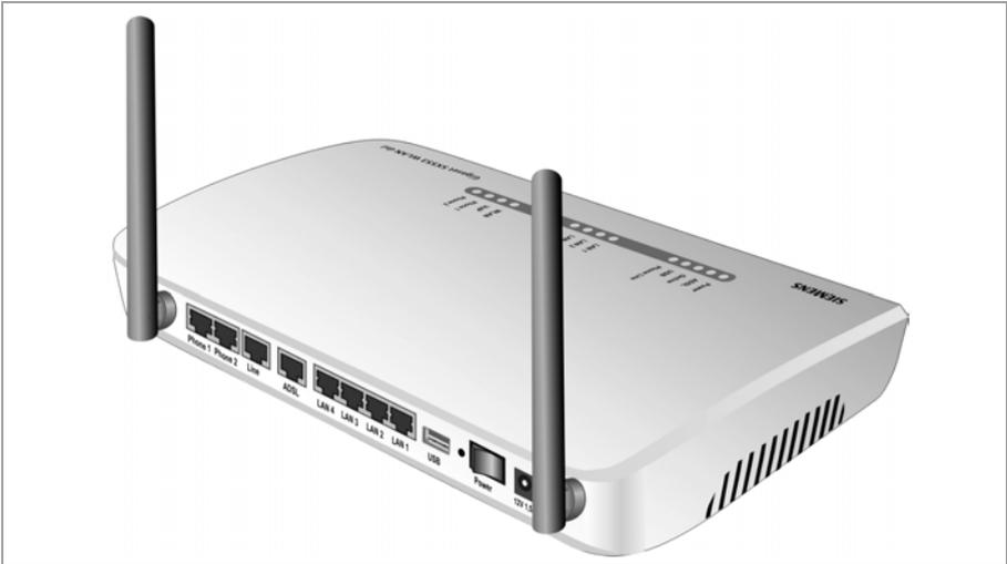
An der Rückseite des Gigaset SX553 WLAN dsl befinden sich die verschiedenen Anschlüsse.
