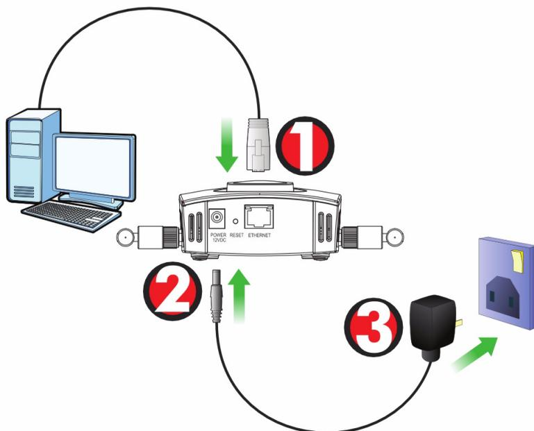
1. Per mezzo del cavo **Ethernet** grigio, collegare la porta ETHERNET ad un computer per la configurazione iniziale.
