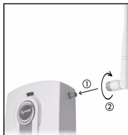
2. Individuare le prese delle antenne presso i lati di NWA1100. Le antenne devono essere perpendicolari al suolo e parallele una con l'altra.
