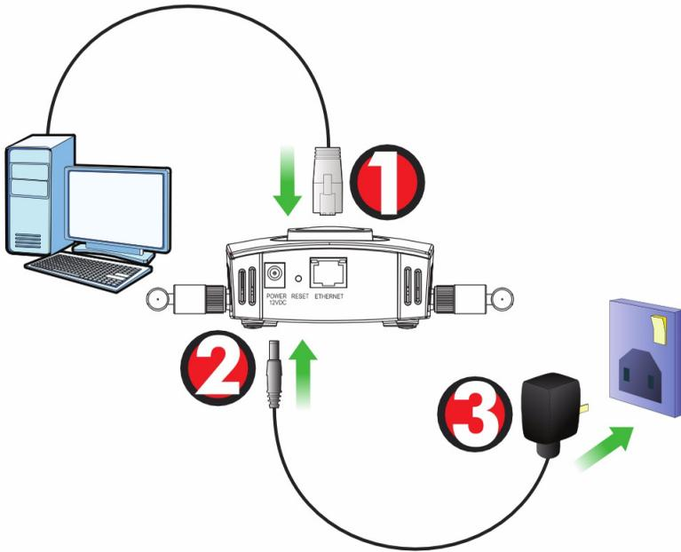
1. 使用灰色的乙太網路線，將 ETHERNET 埠連接至電腦以進行初始設定。
