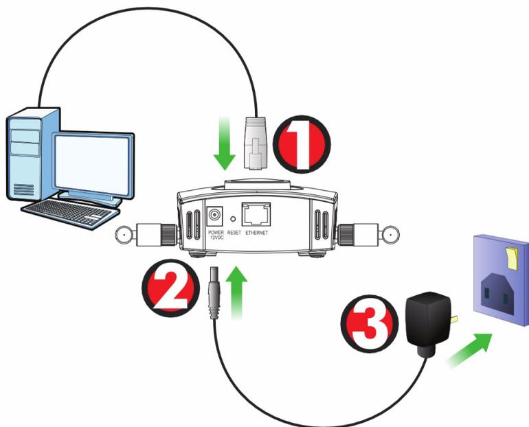
1. 使用灰色 Ethernet（以太网）电缆，将 ETHERNET 端口与一台计算机连接，进行初始配置。
