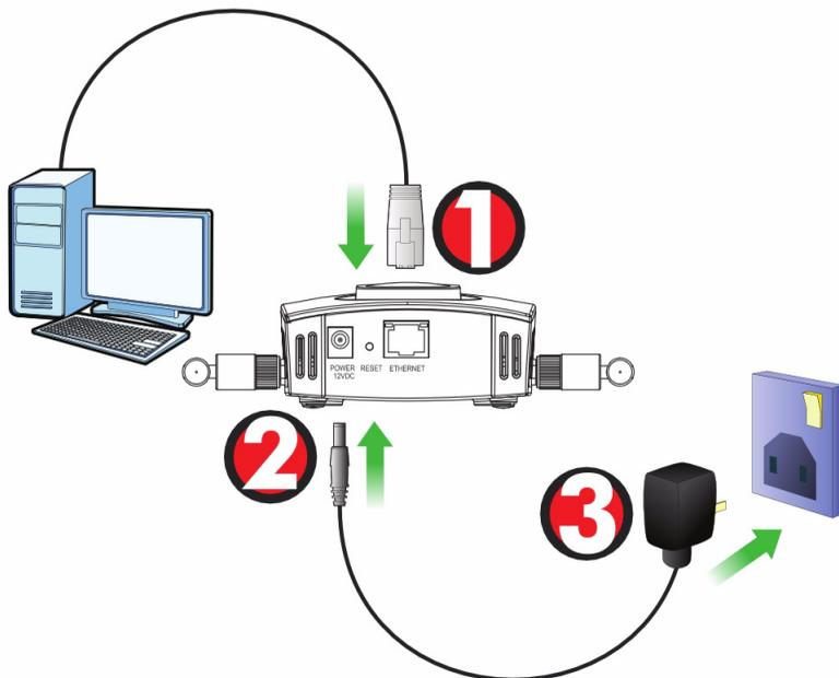
1. Verbinden Sie für die Erstkonfiguration den **ETHERNET**-Anschluss mit dem grauen Ethernet-Kabel mit dem Computer.
