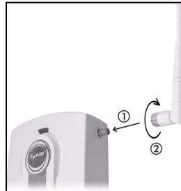
2. Schrauben Sie die Antennen im Uhrzeigersinn in die Antennenanschlüsse. Die Antennen müssen senkrecht zum Boden und parallel zueinander stehen.
