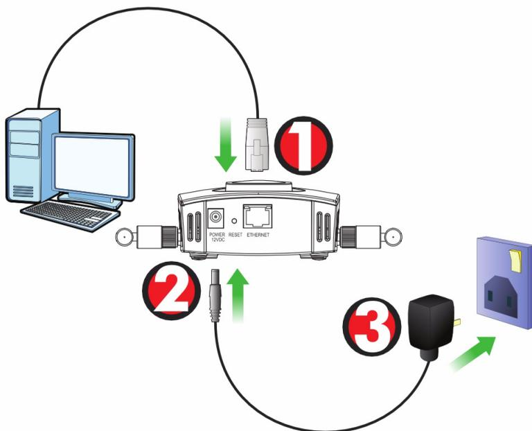
1. Använd den grå Ethernet-kabeln och anslut **ETHERNET**-porten till en dator för inledande konfiguration.
