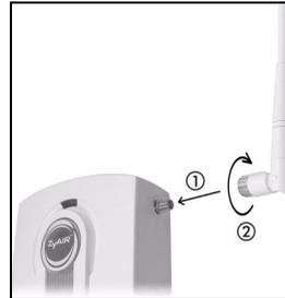
2. Atornille las antenas en sentido horario en los conectores para antenas. Las antenas deberían estar perpendiculares al suelo y paralelas entre ellas.
