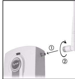
2. Vissez les antennes dans le sens des aiguilles d'une montre sur les connecteurs de l'antenne. Les antennes doivent être perpendiculaires au sol et parallèles entre elles.
