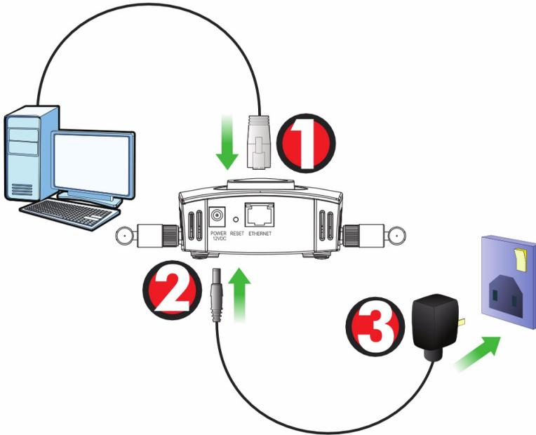
1. Utilisez le câble Ethernet gris, connectez le port **ETHERNET** à un ordinateur pour effectuer la configuration initiale.
