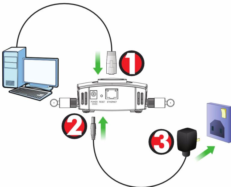
1. При помощи кабеля Ethernet подключите порт ETHERNET к вашему компьютеру, чтобы получить возможность конфигурировать устройство.
