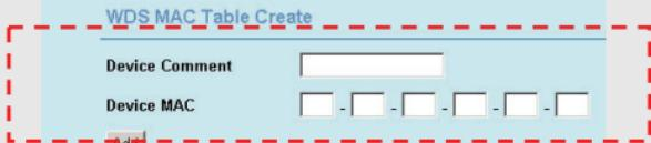
3. Definição da função de segurança Wireless (Repeater->Security->Setup) WDS repeater e Wireless Client utilizam a mesma autenticação e encriptação para a ligação LAN sem fios. Para mais detalhes, consulte o manual de utilizador
