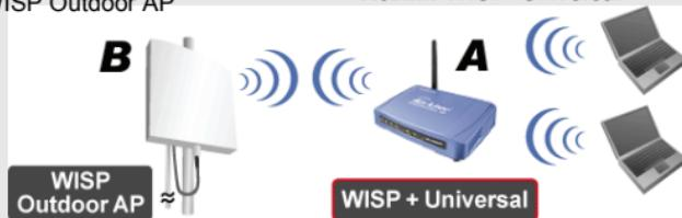
Prosím zadajte SSID zariadenia B do poľa "SSID" a zadajte SSID zariadenia A do poľa "SSID of Extended Interface".
