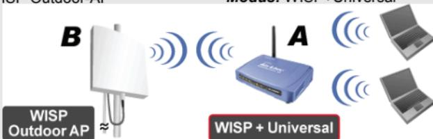
Geben Sie bitte die SSID von Gerät B im Feld "SSID" für die WISP-Verbindung ein, und im Feld "SSID of Extended Interface" geben Sie für die PC-seitige Verbindung bitte die SSID von Gerät A ein.
