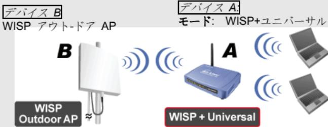
WISP 接続のために「SSID」フィールドに「デバイス B」SSIDを入れて、PC 側接続のために「拡張インターフェースの SSID」フィールドに「デバイス A」SSIDを入れてください。
