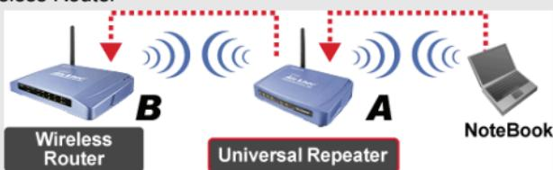
Universal Repeater não necessita que o dispositivo remoto tenha a função WDS
