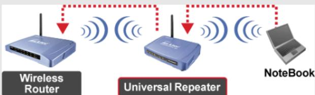
El Repetidor Universal no requiere que el dispositivo remoto tenga la función
