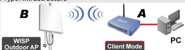
Stellen Sie bitte sicher, dass sowohl Gerät A als auch Gerät B auf den gleichen Kanal und die gleiche ESSID eingestellt sind
