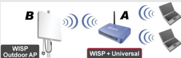
Por favor ingrese al SSID del **equipo B** en el campo "**SSID**" de la conexión WISP, e ingrese el SSID del **equipo A** en el campo "**SSID of Extended Interface**" del lado de la conexión del PC.
