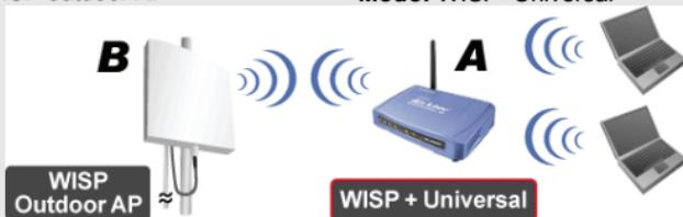
Coloque o SSID do **dispositivo B** no campo “**SSID**” para a ligação WISP, e coloque o SSID do **dispositivo A** no campo “**SSID of Extended Interface**” para o lado da ligação do PC
