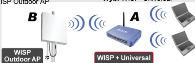
Wpisz SSID urządzenia B w polu **SSID** dla połączenia WISP i SSID urządzenia A w polu SSID rozszerzonego interfejsu (**SSID of Extended Interface**) dla połączenia ze strony komputera PC.
