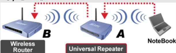
Zařízení v módu univerzální repeater nevyžaduje na "opačné" straně zařízení s podporou funkce WDS.
