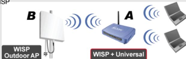
Укажите SSID устройства **Б** в соответствующем поле соединения WISP, а также укажите SSID устройства **А** в поле **"SSID of Extended Interface"** для соединения с компьютером.
