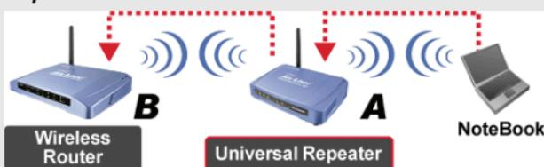
Tryb Universal Repeater umożliwia zestawienie połączenia ze zdalnym urządzeniem nie wyposażonym w funkcję WDS
