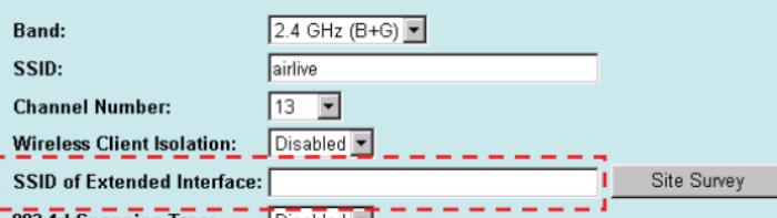
注意: デバイス SSID と Extended インターフェースの SSID は同じであるか、または異なる場合があります。ユニバーサルなリピータモードを使用しているとき、リモート AP/ルータ WDS 機能がオフにされるのを確実にしてください。
