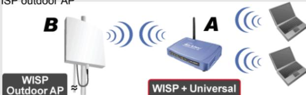
Zadejte prosím SSID ze zařízení B do pole "SSID" pro korektní WISP připojení, a dále zadejte SSID ze zařízení A do pole "SSID of Extended Interface" pro připojení klientských PC.
